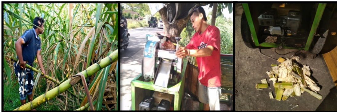
Gambar 2. Proses pengambilan tebu dari kebun dan pemerasan tebu dengan mesin pemeras tebu komersil yang menghasilkan limbah ampas tebu
